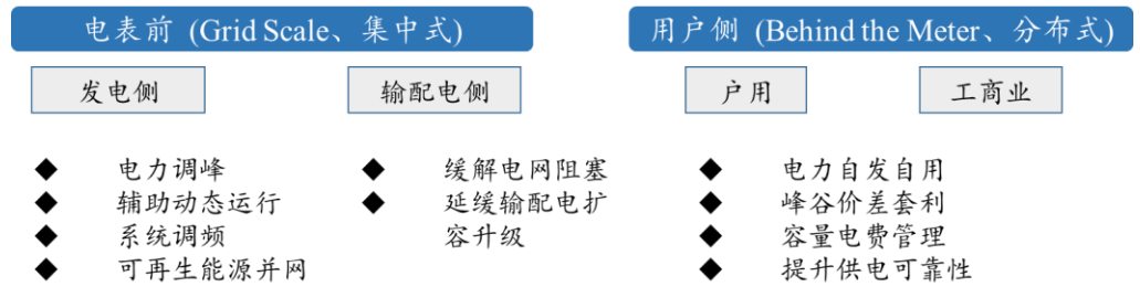
图5：储能的应用场景包括电表前（发电侧、输配电侧）与用户侧
