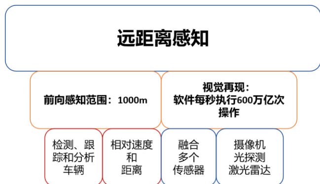
图 24：图森未来的远距离感知系统
