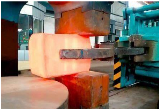
图 32：锻造：对金属施加压力使其变形达到预定形状
