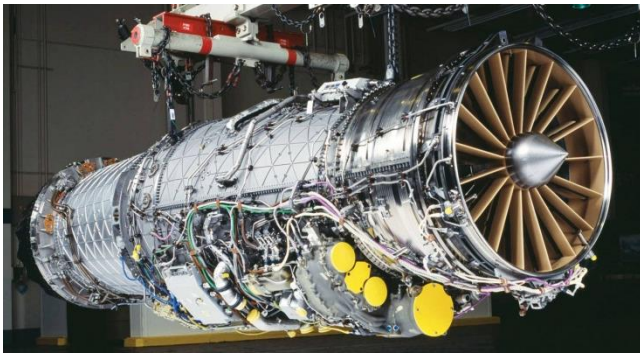
图 7：美国普惠 F-135 发动机：军用小涵道比发动机的标杆
