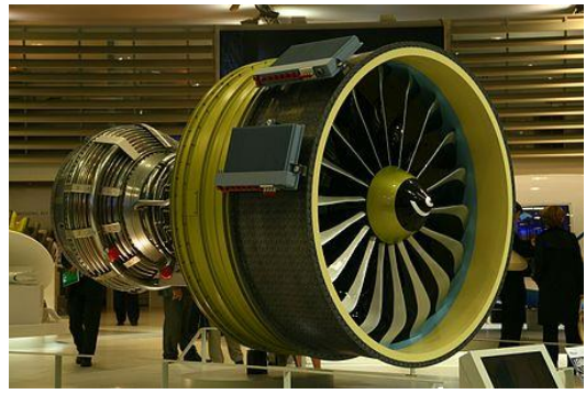
图 8：CFM 国际 Leap 发动机：商用大涵道比发动机的翘楚
