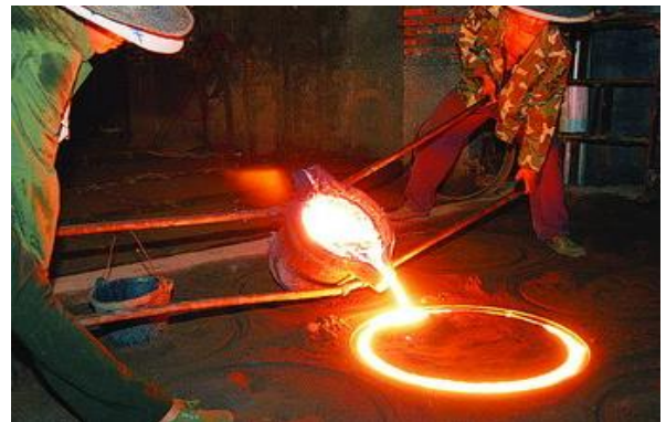
图 33：铸造：液态金属直接浇入模型得到预定形状
