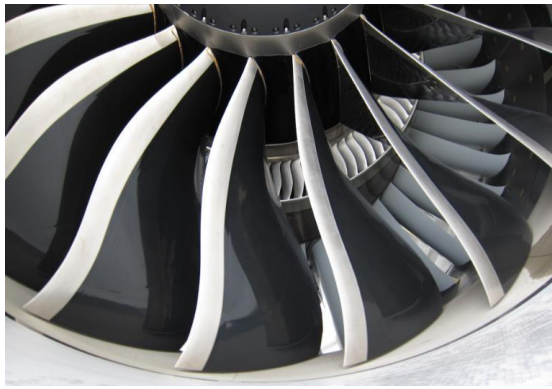
图 30：树脂基复合材料已经在 GE90 发动机风扇叶片上使用
