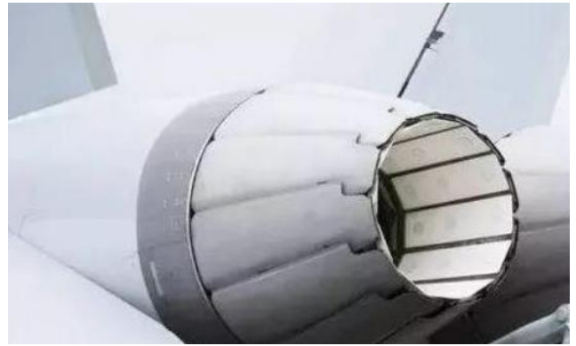
图 31：陶瓷基复合材料已经在 F414 发动机尾喷管上使用
