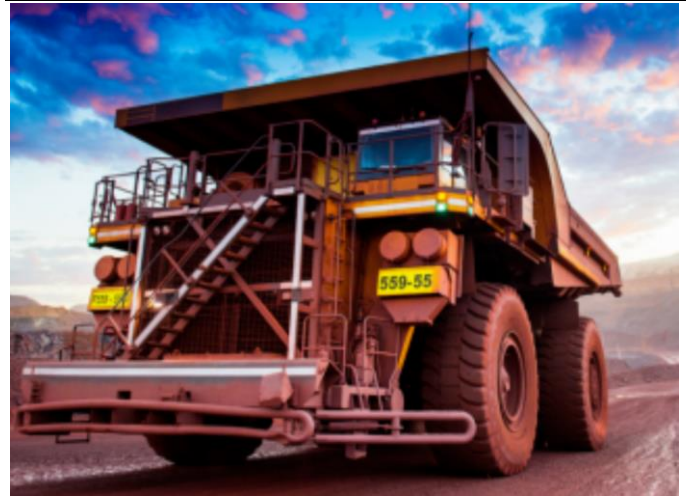
图10: 零排放采矿车辆采用氢能燃料电池动力集成模块
