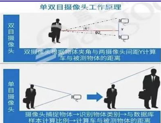
图 7. 单双目摄像头工作原理
