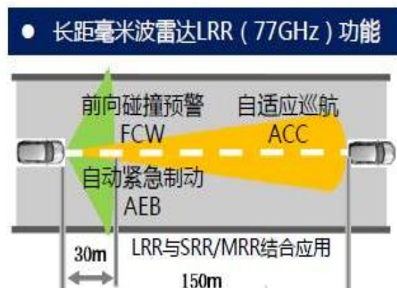
图 22. 长距毫米波雷达 LRR 的功能
