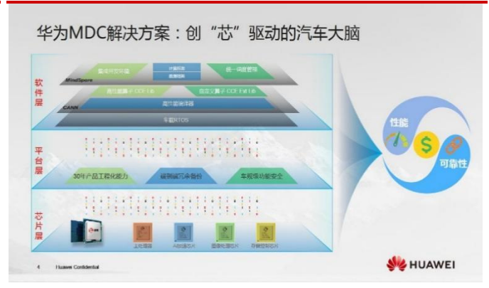
图 6 华为 MDC 解决方案三层架构
