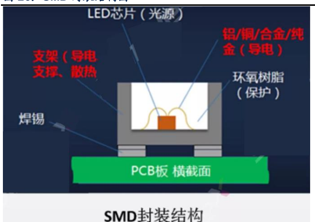
图 26: SMD 封装结构图
