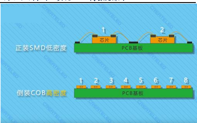
图 31: 倒装可以实现 LED 高密度排列
