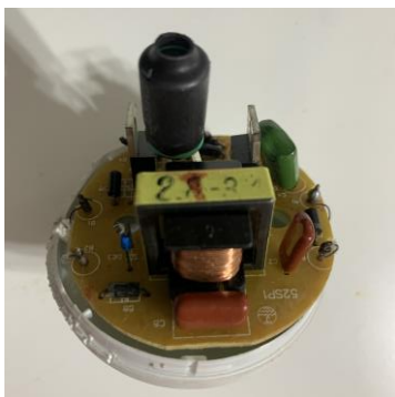
图 57：薄膜电容在节能灯中的应用
