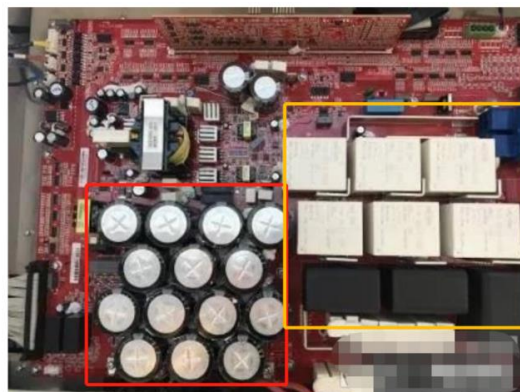
图 42: 古德瓦特 MAX 80KW 逆变器母线电容采用铝电解电容 (红) 和薄膜电容 (黄) 组合设计
