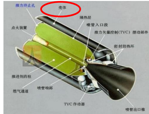
图表 27: 超高强度钢用于固体火箭发动机壳体
