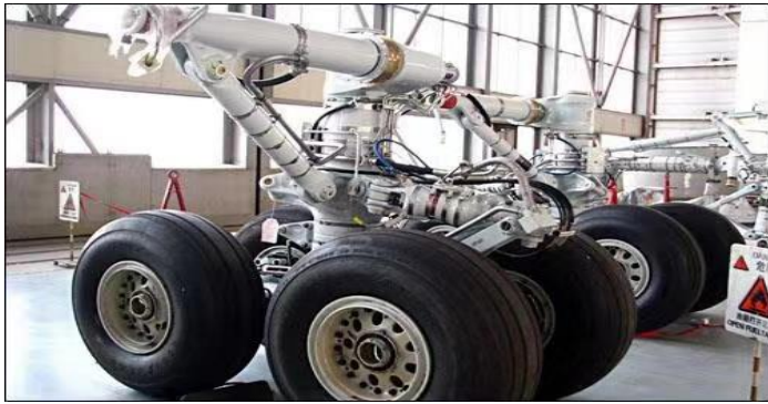
图表 26: 超高强度钢用于飞机起落架
