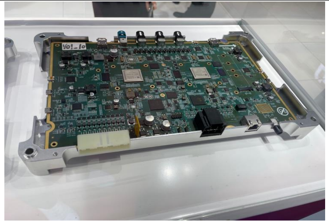
图表 43 基于华山二号 A1000 Pro 的计算平台
