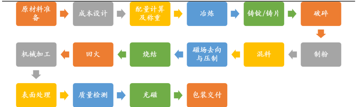
图 5: 钕铁硼磁材制备过程
