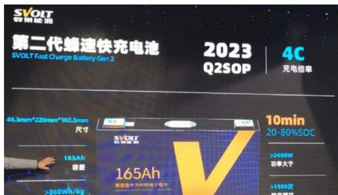
图 65: 蜂巢能源第二代蜂速快充电池: 4C 充电倍率
