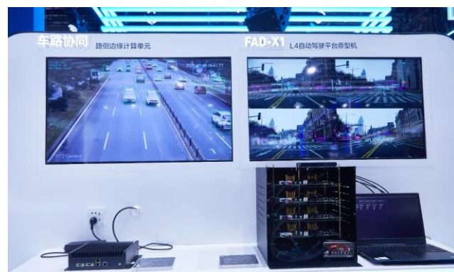
图 73：黑芝麻智能：FAD Edge & FAD X1 车路协同路侧感知计算平台
