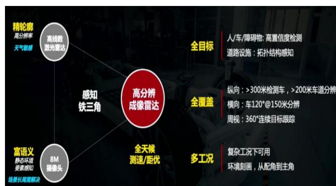
图 38：华为高分辨 4D 成像雷达：毫米波提升分辨能力
