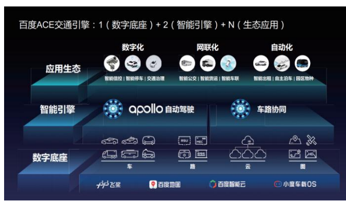
图 50：百度 ACE 交通引擎总体架构
