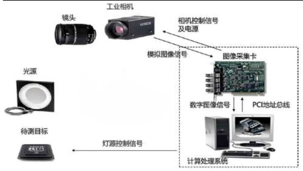
图9: 机器视觉设备的软硬件组成
