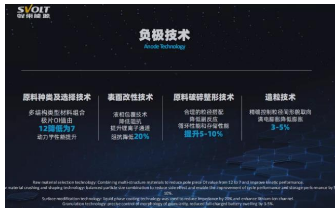
图表 33: 蜂巢能源快充电池的负极技术
