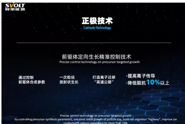
图表 32: 蜂巢能源快充电池的正极技术
