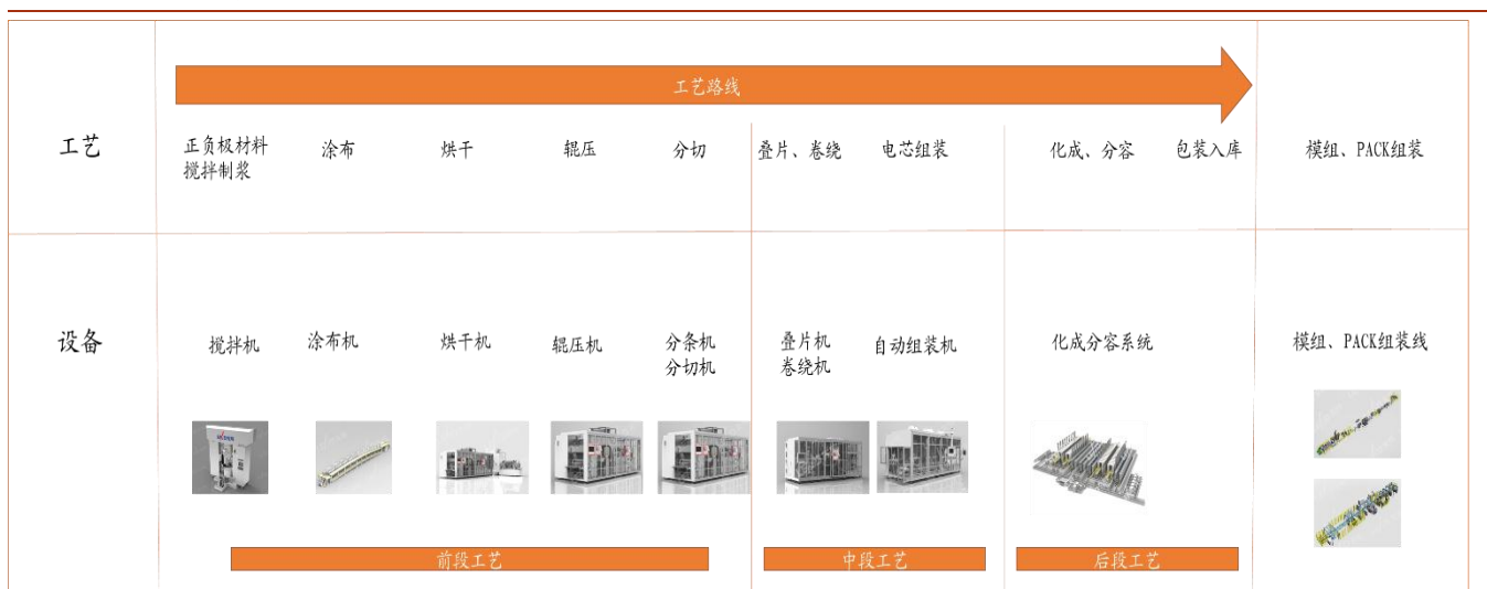
图4：动力锂电池生产工艺及对应设备
