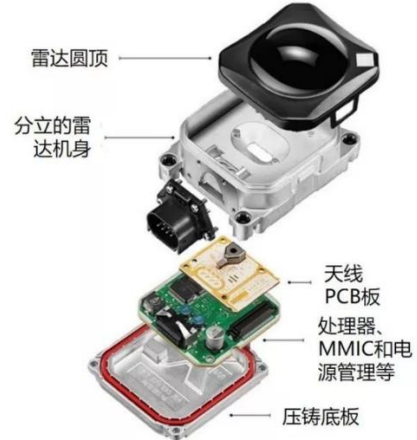
图表 24: 博世第三代毫米波雷达构成
