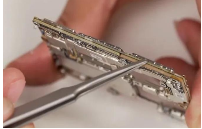
图表 35：Mate 40 Pro 5G 主板采用双层设计结构
