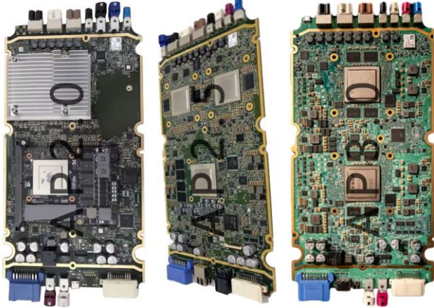
图表 23: 特斯拉 Autopilot 域控制器 PCB 板
