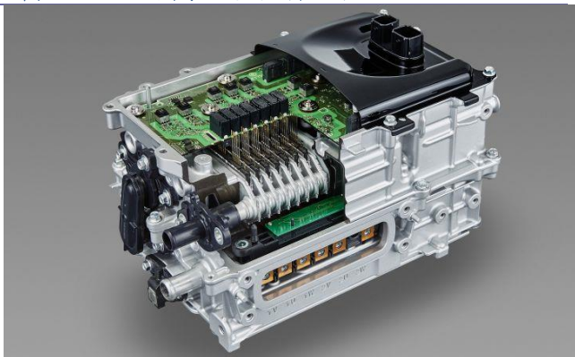
图表 25: PCB 用于电机控制电路
