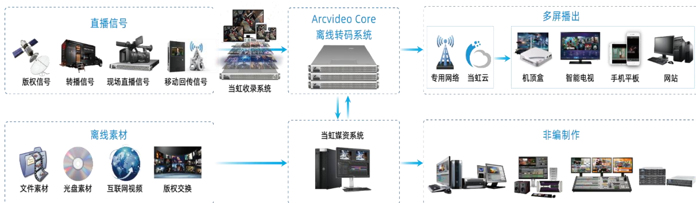
图 12：公司 CPU+GPU 架构应用：离线转码系统
