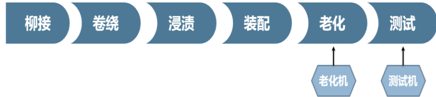
图 39：电容器老化测试设备在生产流程中的应用
