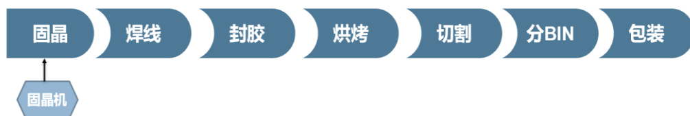
图 32：固晶机在 LED 封装工艺流程中的应用
