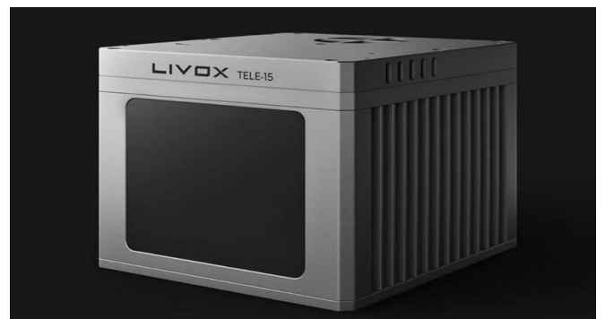
图 25: 大疆 Livox Tele-15 激光雷达
