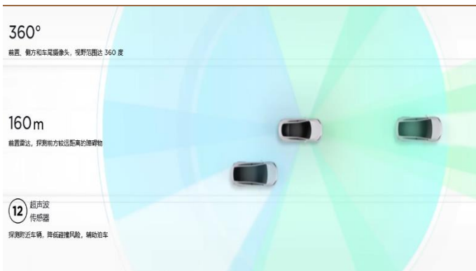
图 5： 特斯拉摄像头辅以毫米波雷达和超声波传感器
