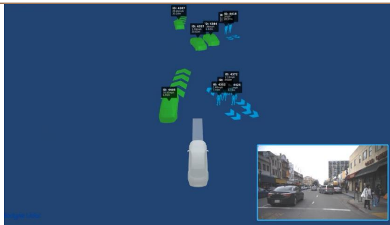
图 53: 半固态激光雷达+Vella 软件布局 ADAS
