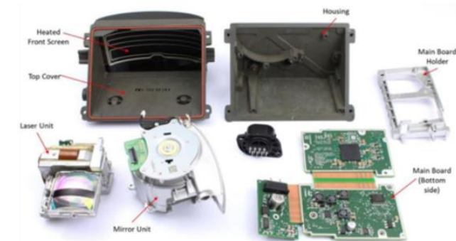
图 34: 法雷奥 Scala 结构拆分
