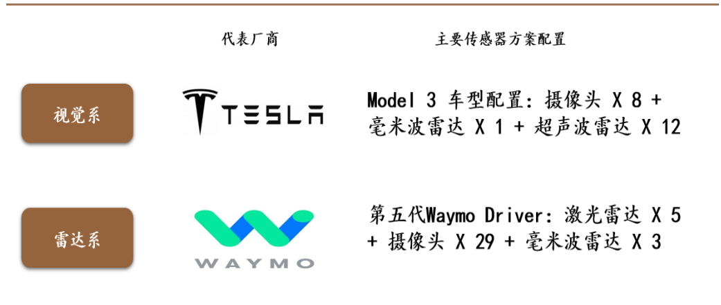
图 4：以特斯拉代表的视觉系和以 Waymo 代表的雷达系
