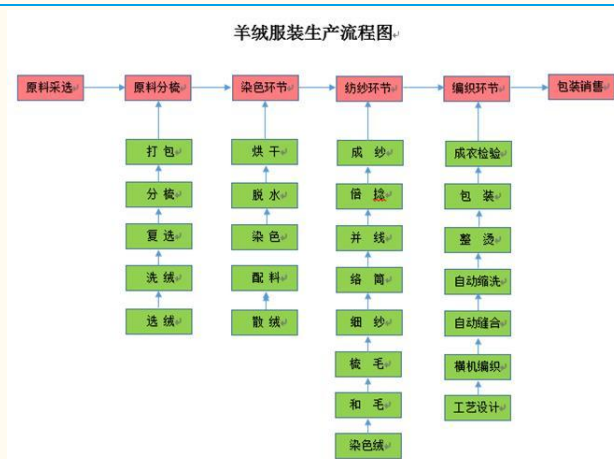
图表 29：公司羊绒服装生产流程示意图
