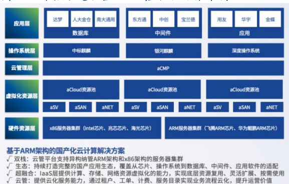
图 10：深信服超融合 ARM 虚拟化方案架构
