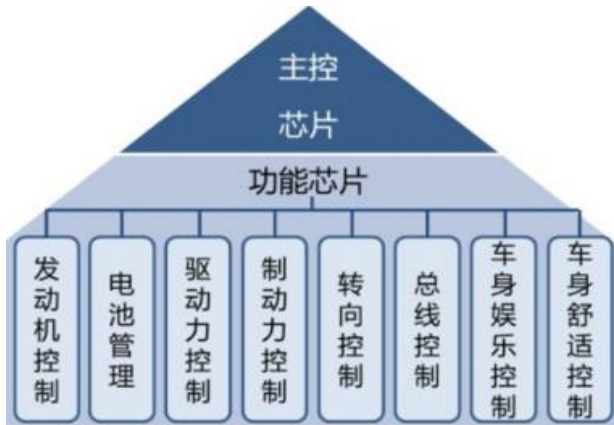
图 71: 主控芯片和功能芯片配合对车身进行控制
