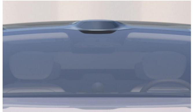
图 118: 蔚来 ET7 在车顶搭载一个激光雷达
