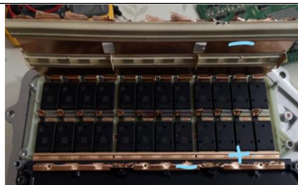
图 52: Model 3 逆变器上的 SiC MOSFETS 模块
