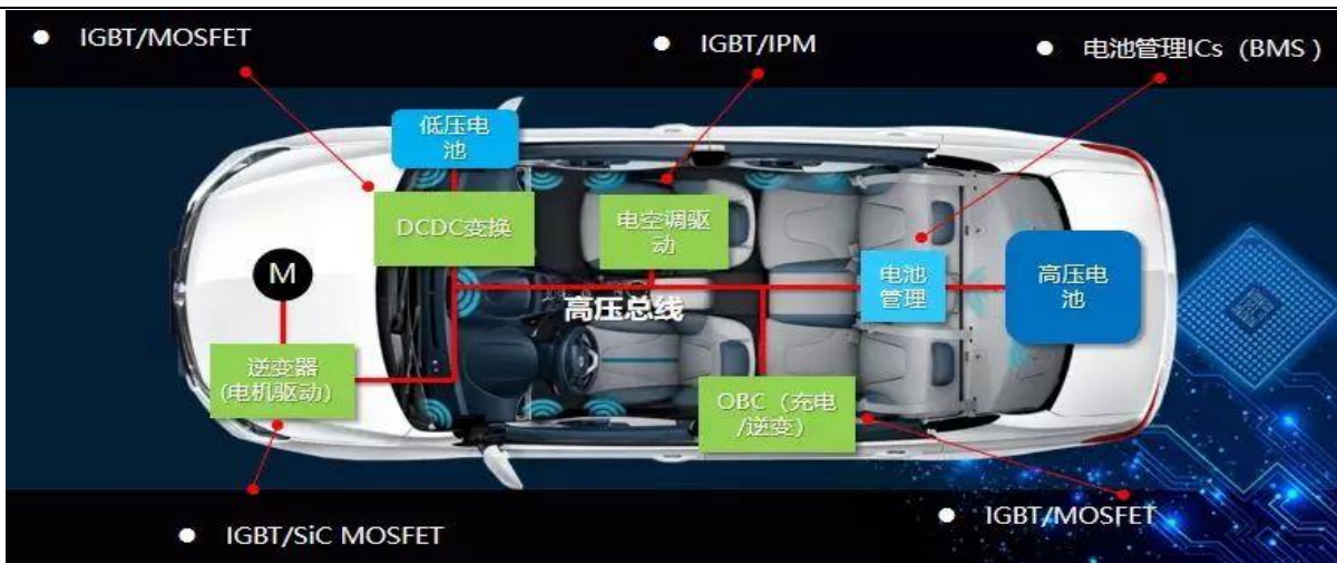
图 50: 汽车功率器件应用在车身各个环节
