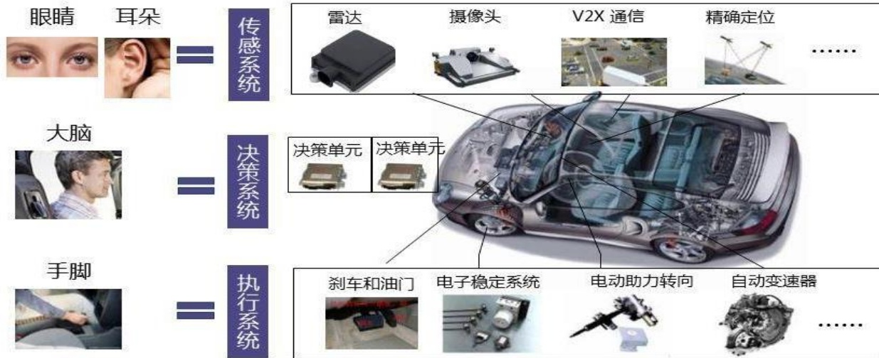
图 20：实现汽车智能网联的传感系统、决策系统与执行系统
