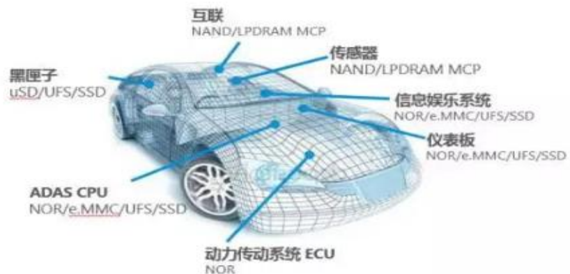
图 77：存储产品在汽车各个系统均有应用
