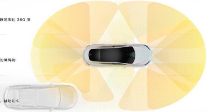
图 109: 特斯拉 Model 3 搭载了 12 个超声波传感器
