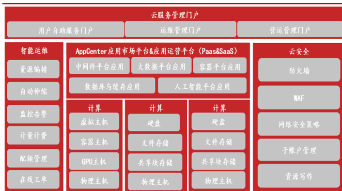
图 14 QingCloud 企业云平台功能架构图
