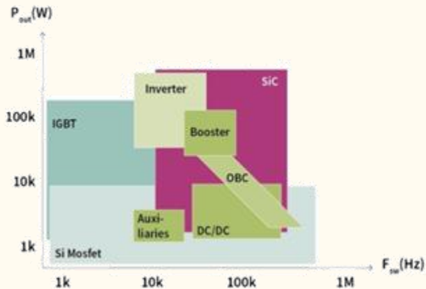
图表 27: SiC 在高开关高频和高功率应用优势明显
