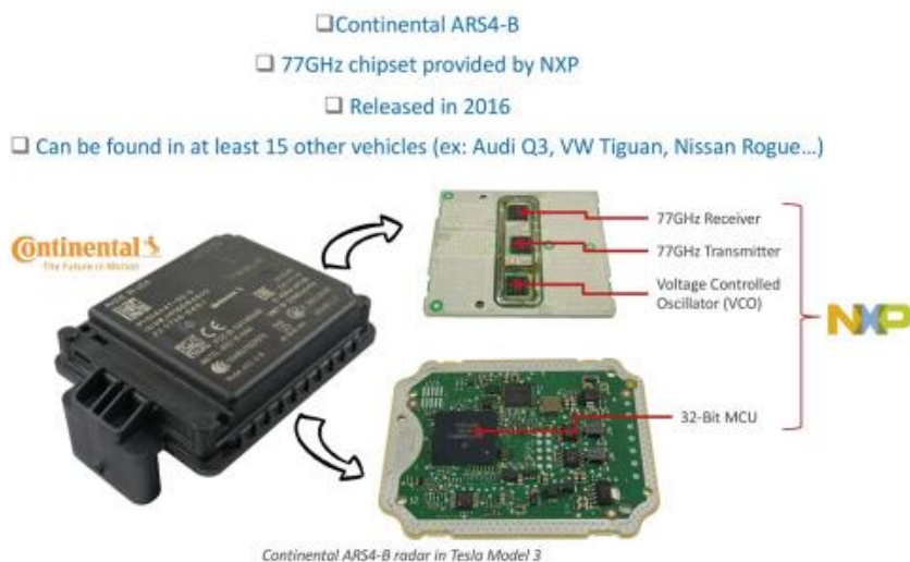
图10: 特斯拉毫米波雷达内部结构拆解
