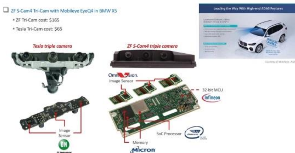
图9: 特斯拉 Model3 三摄与采埃孚三摄模块对比
