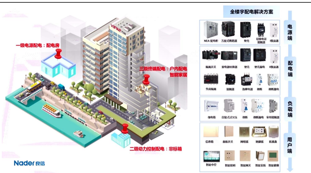
图 33：智能楼宇存在三个配电环节
