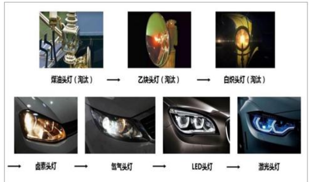
图表 17：汽车车灯从卤素→氙气→LED→激光灯的升级
