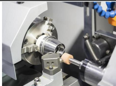
图 33：磨床加工圆柱内圆
