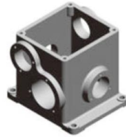
图 23: 镗床加工后的箱体
