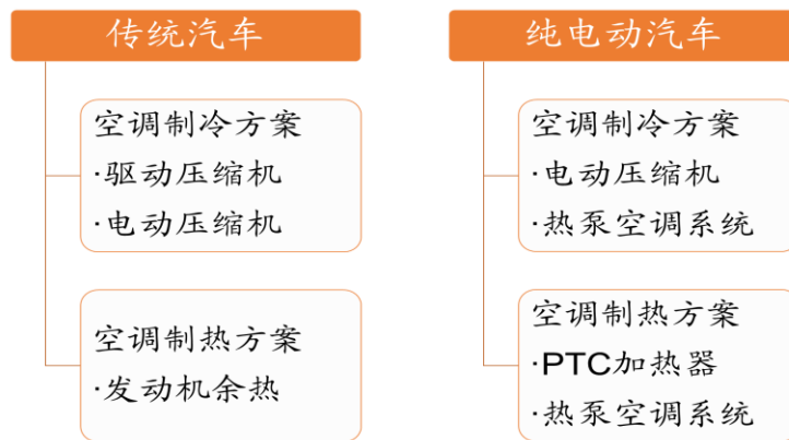
图2：传统汽车与新能源汽车空调技术路线
