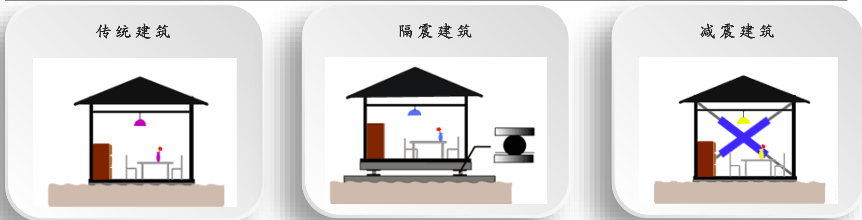
图：不同抗震技术原理对比
