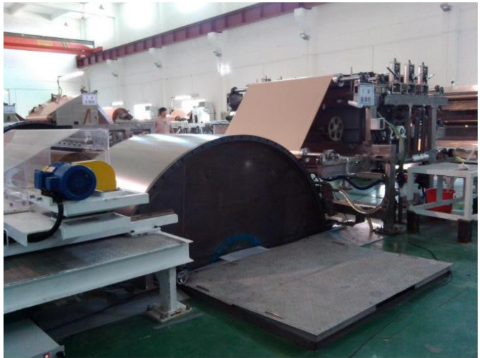
图表 29 阴极辊是铜箔生产中的核心部件
