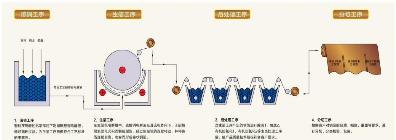
图表 28 电解铜箔制备工艺流程图
