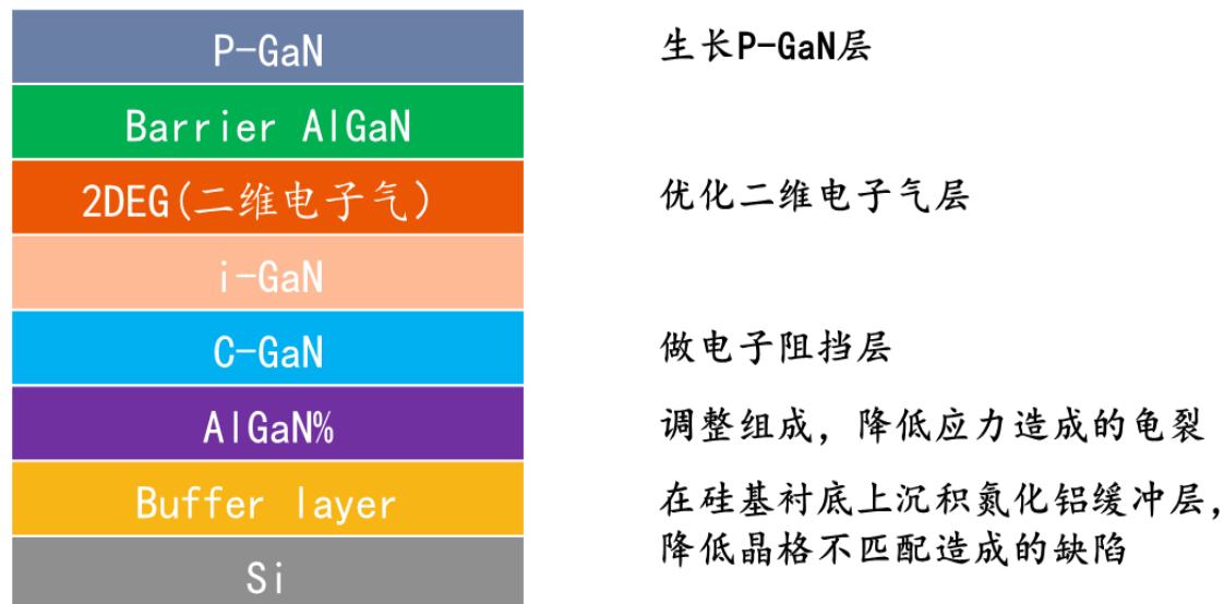
GaN-on-Si外延片制作过程示意
