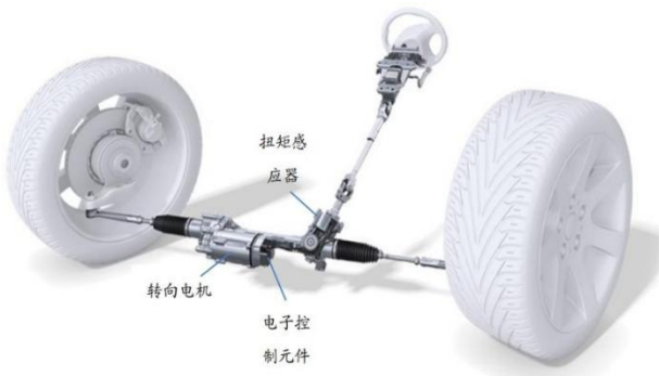
图表 122: 博世 Servolectric 电子助力转向系统
