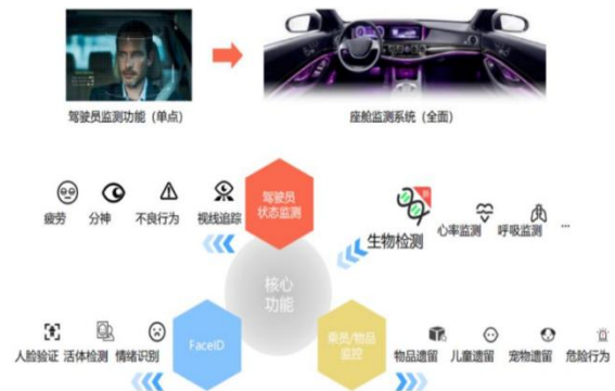
图表 176: DMS 组成及工作原理
