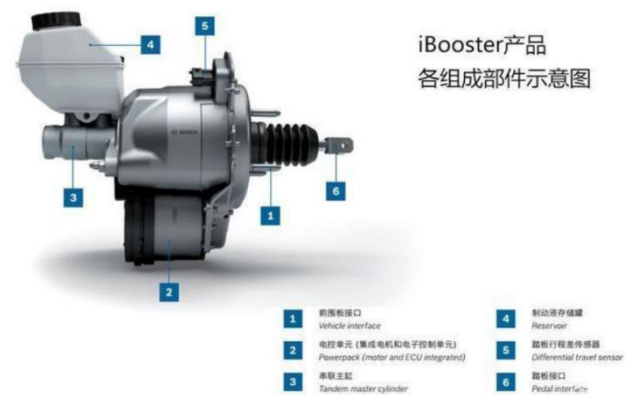
图表 123: 博世 iBooster 智能制动系统
