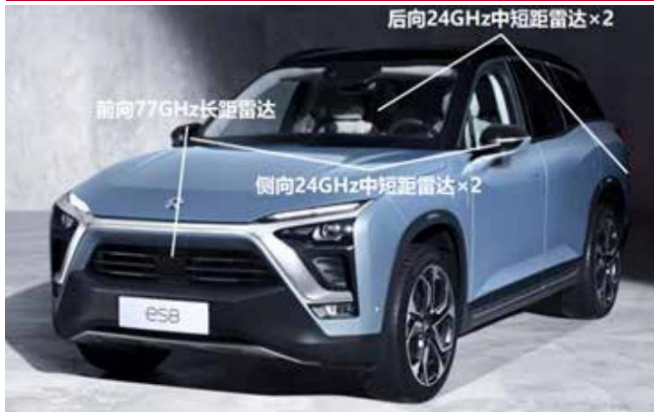
图表 94: 典型车载雷达系统搭配 (1+2+2)
