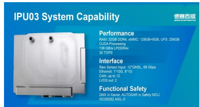
图表 142: 德赛西威 ADAS/AD 域控制器
