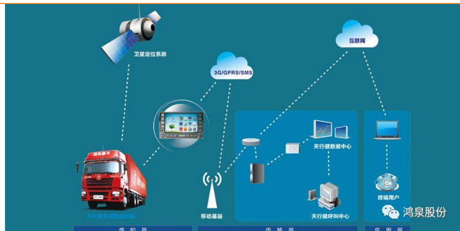
图 32：公司为陕汽打造“天行健”车联网系统
