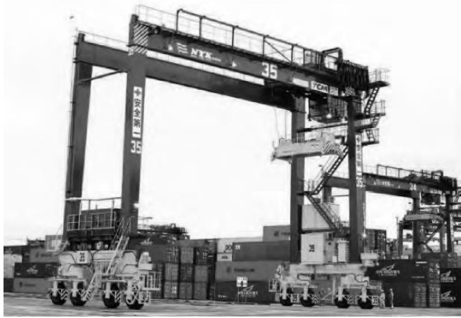
图41: 配备超级电容的器能量管理装置的起重机
