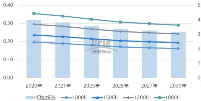
图29: 光伏地面电站 LCOE 持续下行, 元/kwh
