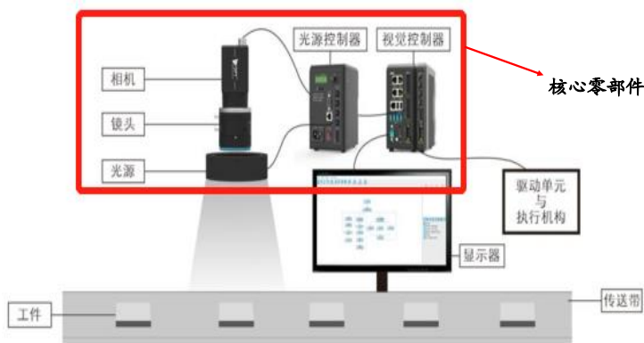
图 22: 机器视觉系统是硬件和软件的组合
