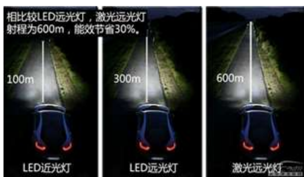
图 8: 宝马激光大灯与 LED 大灯照明效果对比
