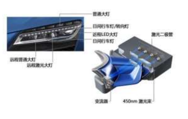
图 11: 奥迪 A8 搭载的矩阵式激光大灯结构
