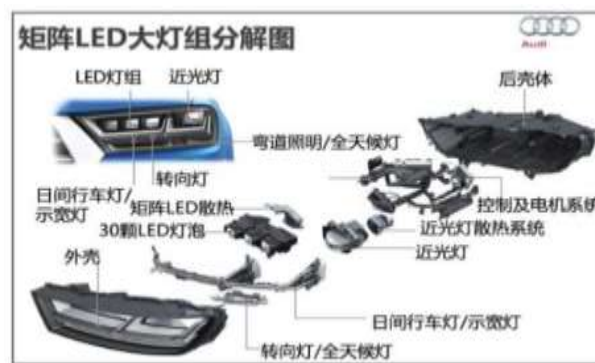
图 14: 奥迪矩阵式 LED 大灯组拆解
