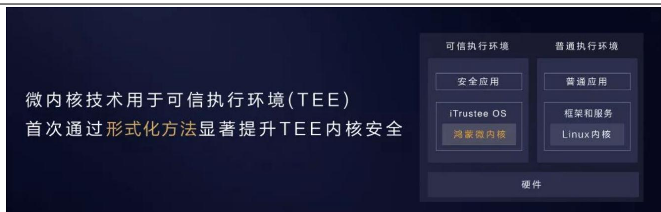
图 12：基于微内核架构重塑终端设备可信安全
