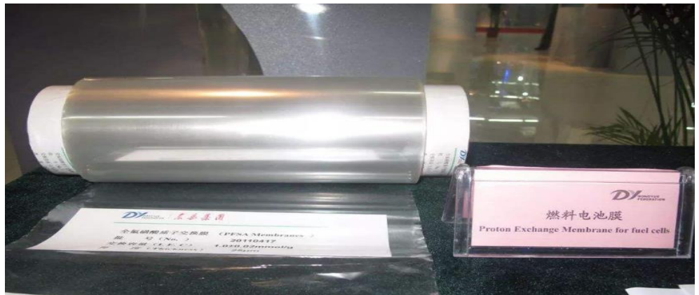
图21: 东岳质子交换膜的交换容量可达 1mmol/g, 厚度可达 15 微米以下
