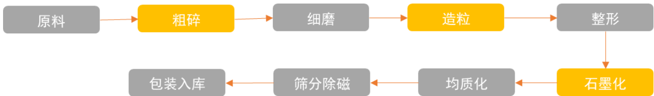
图 7：凯金能源人造石墨负极工艺流程图
