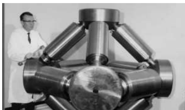
图 5：霍尔博士和当时的 HPHT 钻石合成机器
