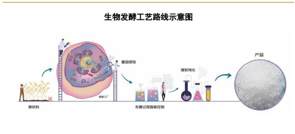
图 20：生物发酵工艺路线示意图
