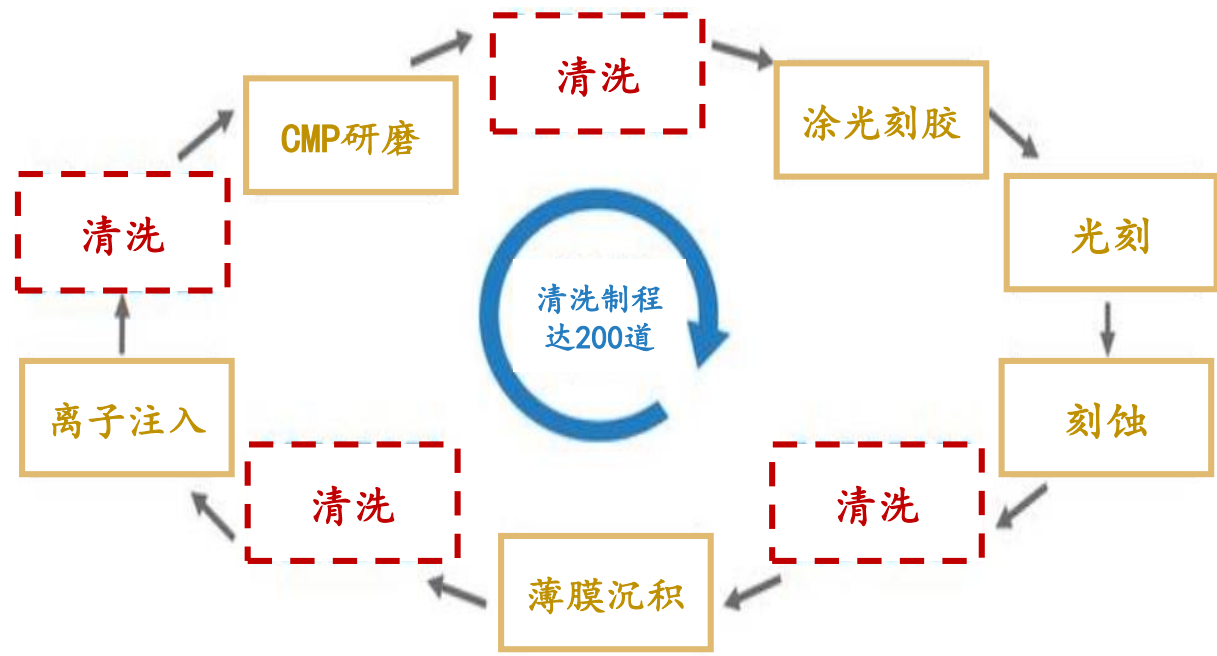
清洗工艺在20nm制程达200道，是先进制程芯片最关键工艺之一
