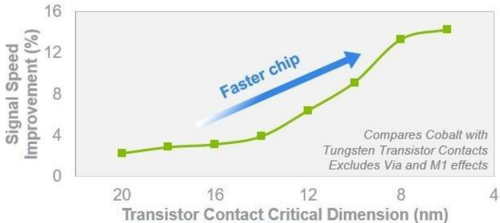
钴可用于更多层的金属导线互连
