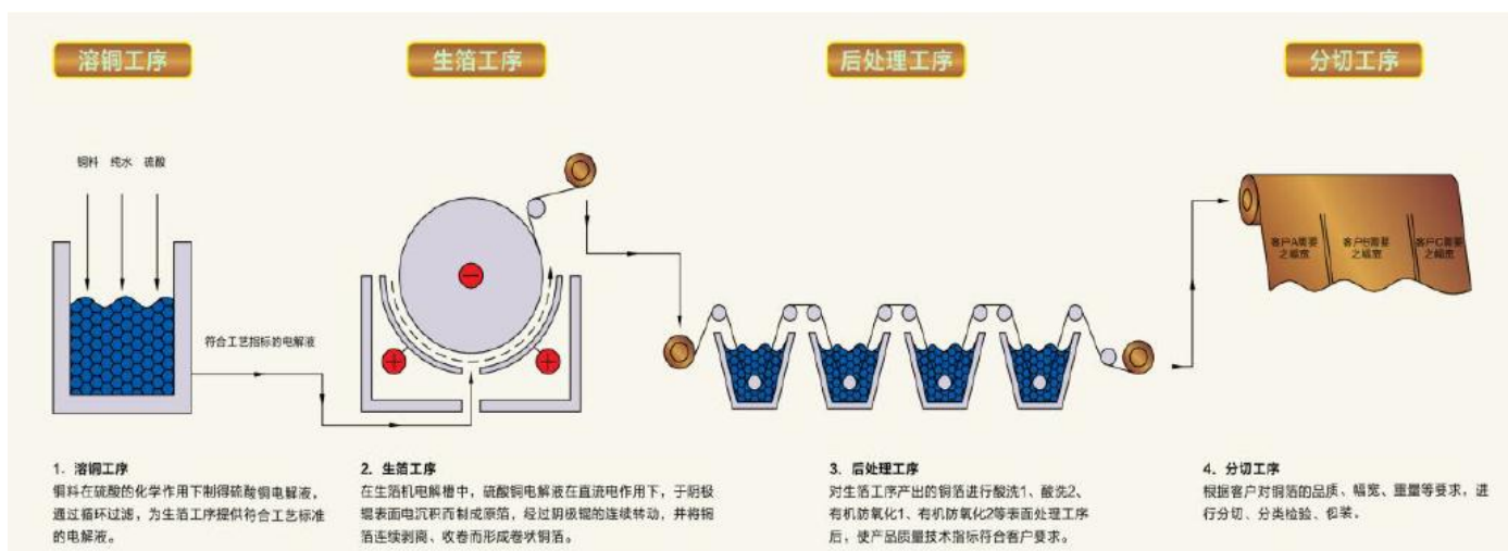
图 30：电解铜箔生产工艺流程
