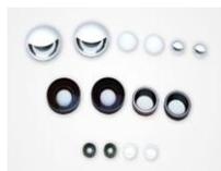
玻璃非球面透镜是选用低熔点优质的光学玻璃，采用精密控制的批量热模压技术进行生产，主要包括从产品模具的设计、加工到产品的制造。
