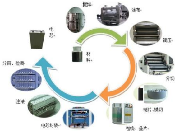
图 11：锂电设备生产流程
