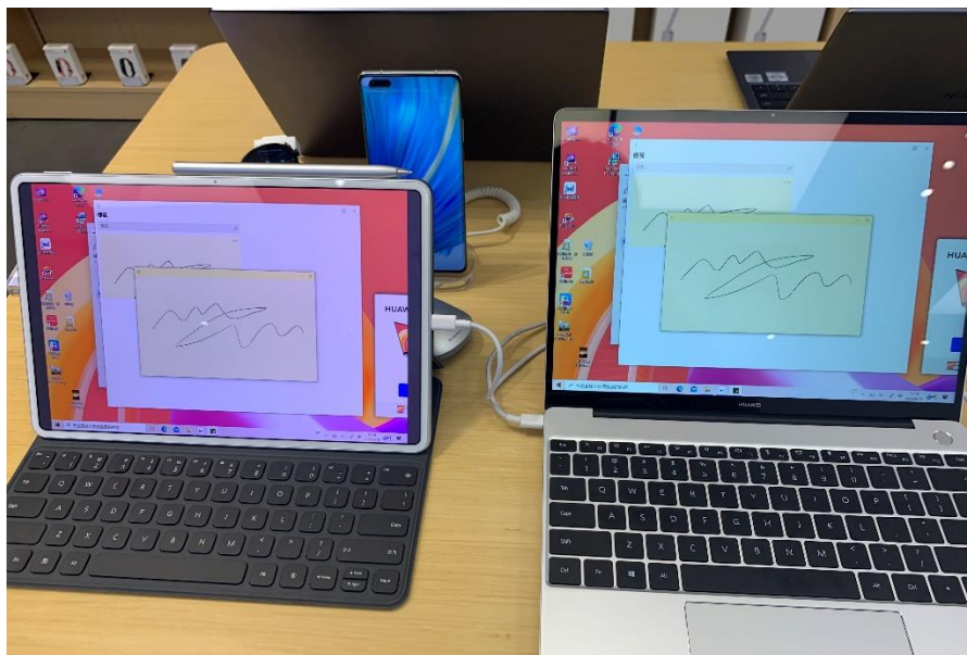
图 4：镜像模式下可以在平板上进行绘画后在 PC 端显示
