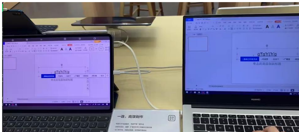
图 15: 镜像模式中, 用户在平板上输入内容时, 能同时在 PC 上显示出来, 未感觉到有明显的时延
