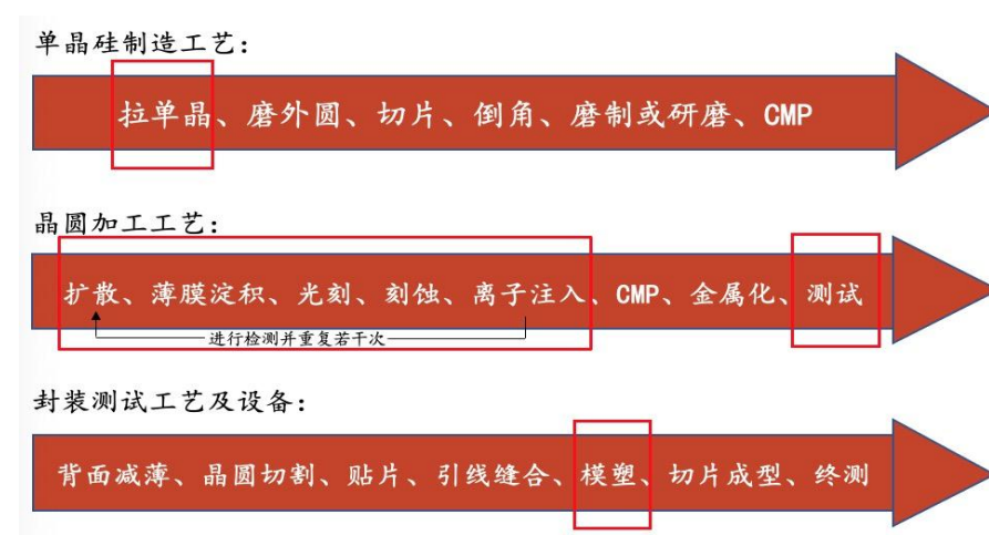
图 13：真空泵在半导体制程上的应用（红色方框内）
