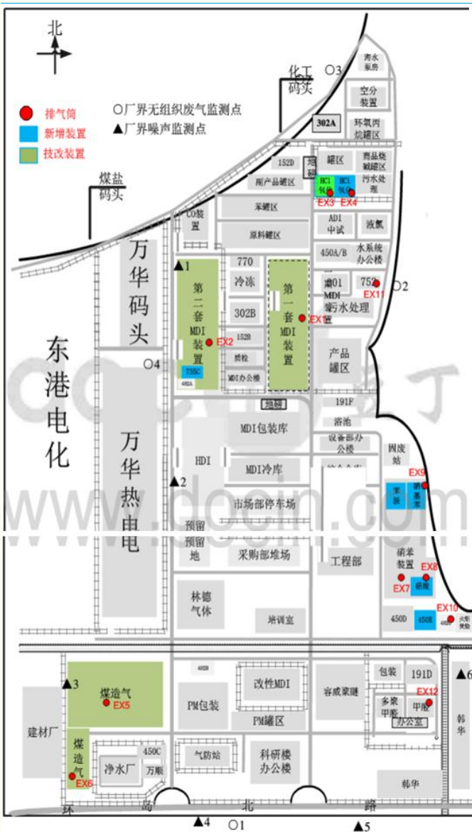
图 3-2 万华工业园平面布置及监测点位布设图
