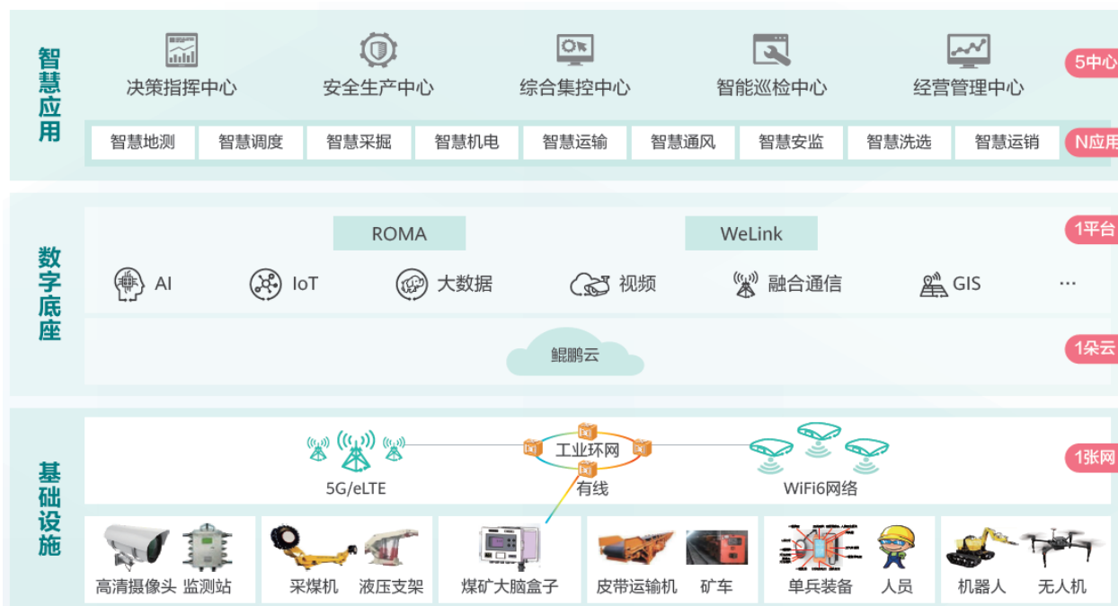
图3：华为智能矿山联合解决方案采用“3个1+N+5”的智能矿山整体架构
